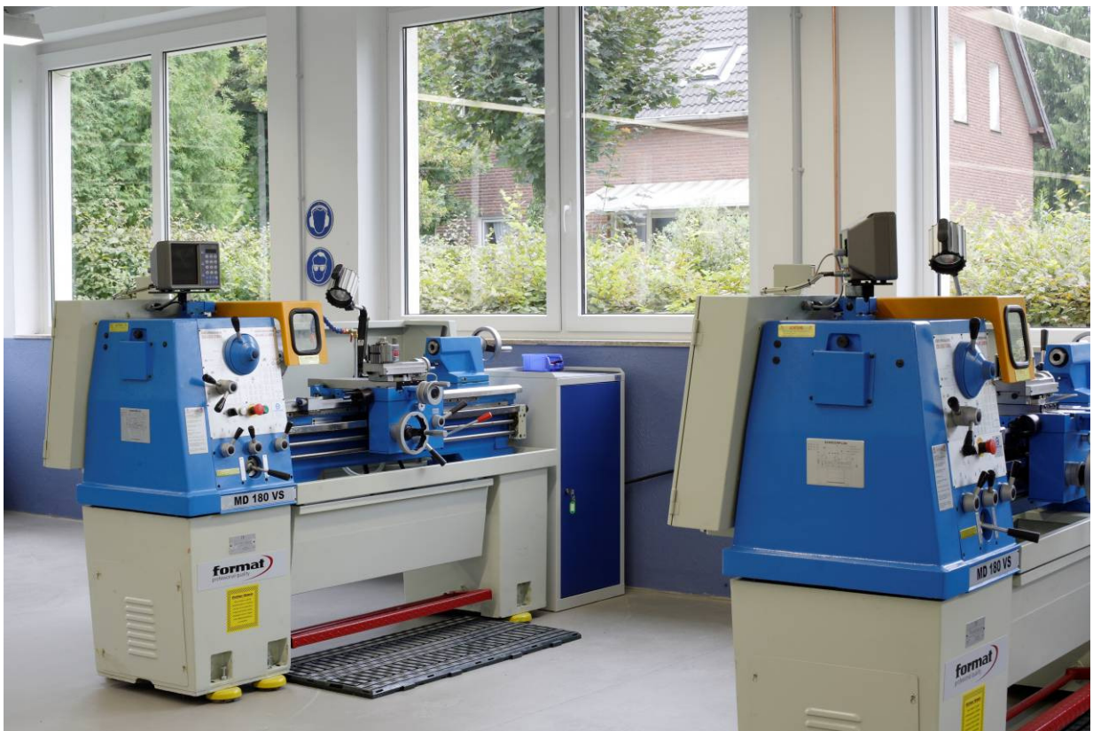
Konventionelle Drehmaschinen mit Digitalanzeige und einstellbarer konstanter Schnittgeschwindigkeit
